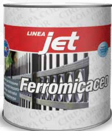
**COSA È:** Smalto Ferromicaceo ad effetto antichizzante, anticorrosivo formulato con fosfato di zinco, ossido di ferromicaceo ed alluminio lamellare
