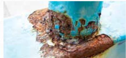
**CORROSIONE SELETTIVA** avviene solo in uno dei componenti della lega metallica
