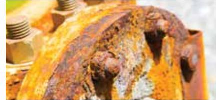
**CORROSIONE LOCALIZZATA** si presenta solo in alcuni punti della superficie con formazione di ulcere, crateri e cricche
